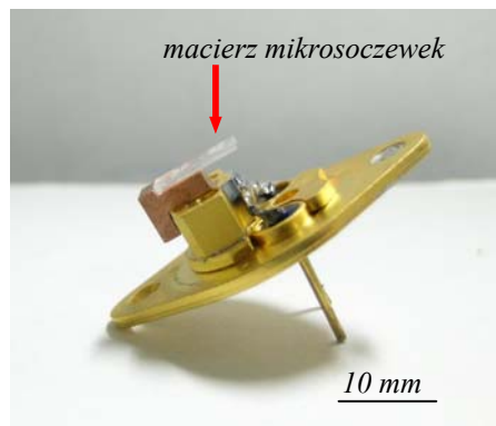
macierz diod laserowych w obudowie TO3 z układem optycznym formującym wiązkę
