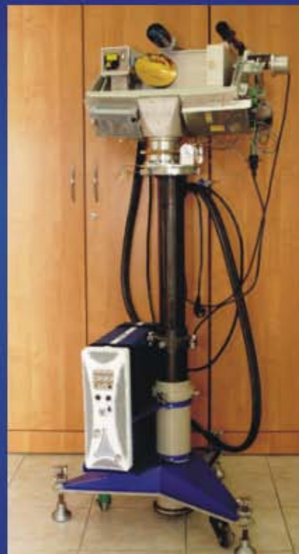
Schemat blokowy i widok systemu lidarowego
