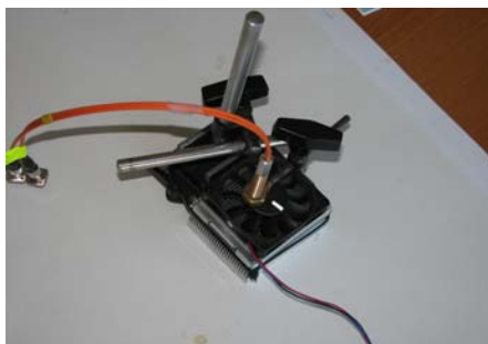
Rys. 1. Głowica modułu czujnika do pomiaru prędkości obrotowej
